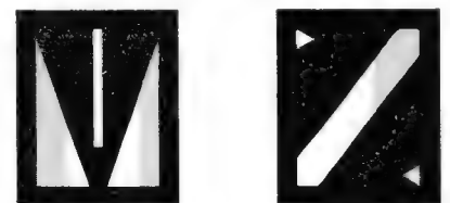
Links: Bild 5. Leuchtschirmmaske (schwarz) für die Verwendung in Brückenschaltungen; das weiße Leuchtfeld ist infolge Verstimmung nach rechts ausgewandert. An den schrägen Kanten der Maske lassen sich sehr geringe Unterschiede in der Höhe der leuchtenden Dreiecke gut erkennen
